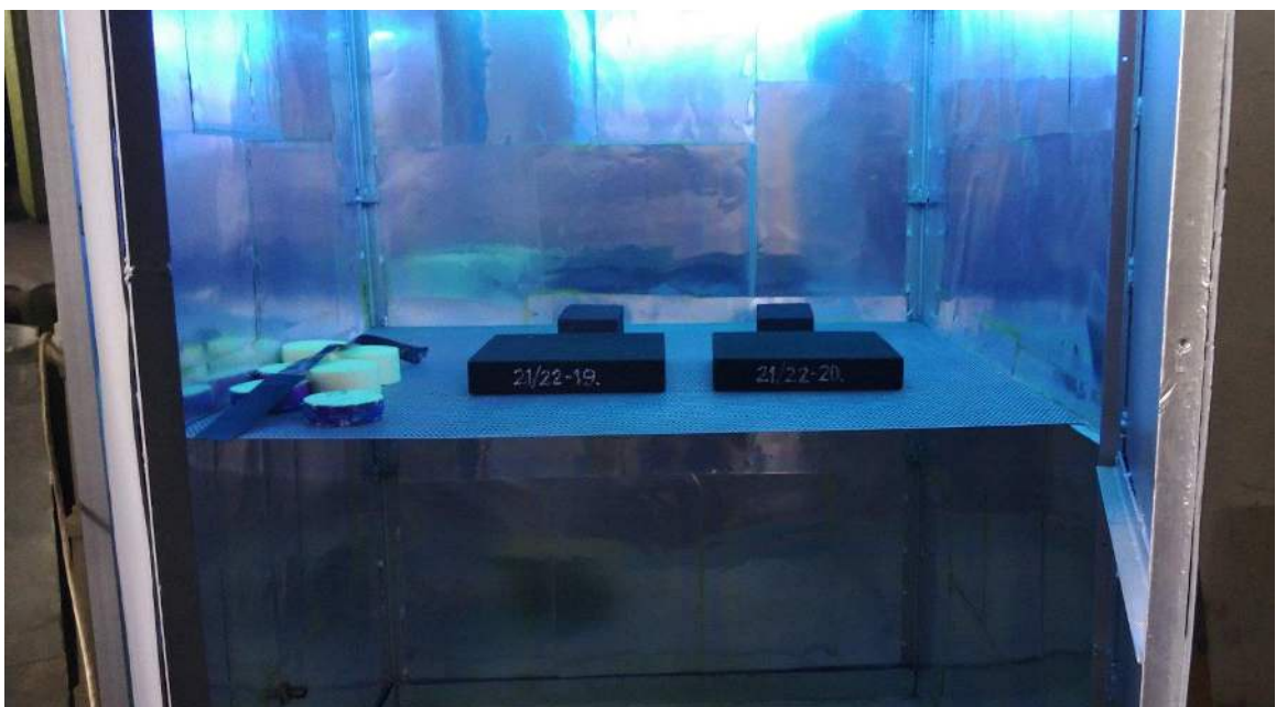
Рисунок 9 – Загальний вигляд дослідних зразків теплоізоляційного матеріалу марки піноскла ПС Стандарт виробництва ТОВ «НПП Технологія» під час опромінення
