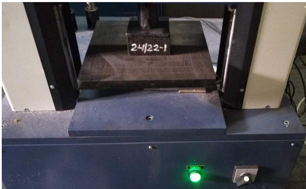
Рисунок 5 – Проведення випробування міцності на стиск при 10% деформації зразків теплоізоляційного матеріалу піноскла ПС Стандарт виробництва ТОВ «НПП Технологія»
