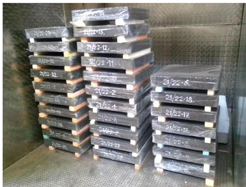
Рисунок 11 – Висушування дослідних зразків в двох температурних режимах
