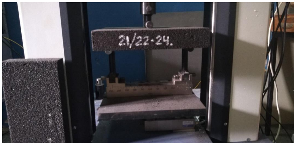
Рисунок 7 – Проведення випробування та типова експериментальна залежність міцності при згині зразків піноскла ПС Стандарт виробництва ТОВ «НПП Технологія»
