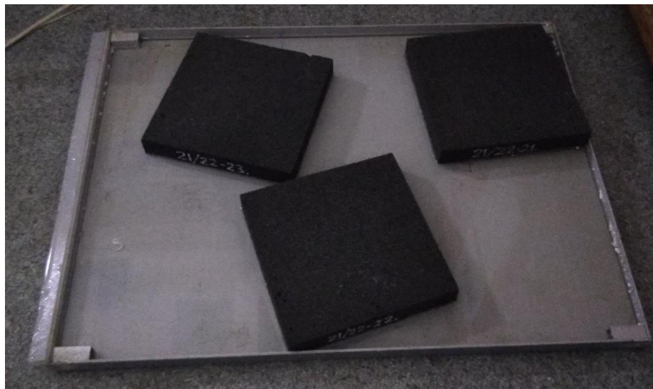
Рисунок 10 – Зволоження дослідних зразків теплоізоляційного матеріалу марки піноскла ПС Стандарт виробництва ТОВ «НПП Технологія»
