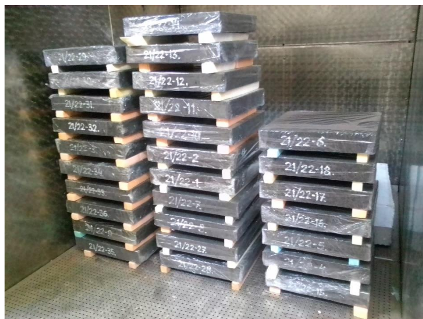
Рисунок 11 – Висушування дослідних зразків в двох температурних режимах
